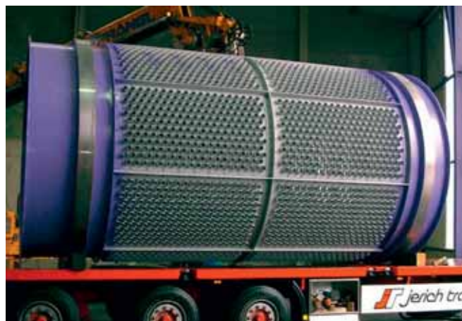
Abb. 2-7 Siebtrommel in schwerer Ausführung (www.stahlbau-meier.at)
