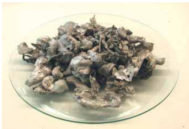
Abb. 1-5 Aluminium-«Nuggets» aus KVA-Schlacke (Trockenaustrag) [5].
