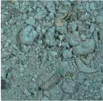
Abb. 8.1 Foto einer grobkörnigen Schlacke (Bildlänge 20 cm)
