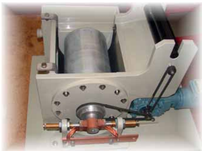
Abb. 4 Kontinuierliches Elektrolysesystem mit rotierender Aluminiumkathode.
