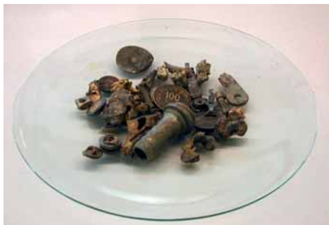
Abb. 1-6 Messingstücke aus KVA-Schlacke (Trockenaustrag) [5].
