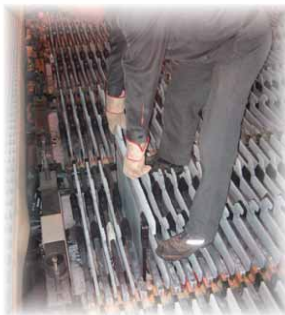
Abb. 5 Kontinuierliche Zinkblechproduktion mit rotierender Aluminiumkathode.
