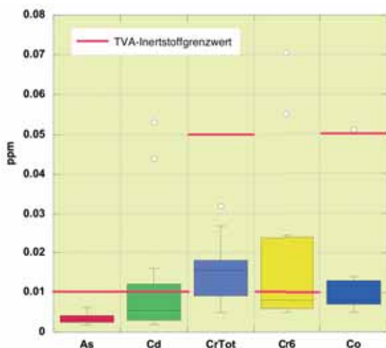
Abb. 14c Die Inertstoffgrenzwerte von Chromat und Cadmium werden teilweise überschritten, die Medianwerte liegen aber darunter.
