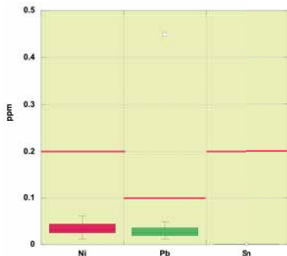
Abb. 14b Die Eluatgehalte der Schwermetalle Ni, Pb und Sn liegen bei allen Proben deutlich unter den TVA Inertstoff-Grenzwerten.
