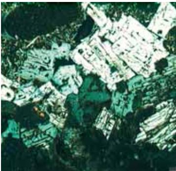
Abb. 8.7 Durchlichtaufnahme von neu gebildete, rel. grosse Ca-Al-Silikate / Melilith (L 1,3 mm)
