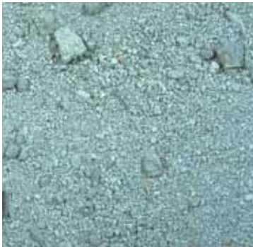
Abb. 8.4 Foto einer feinkörnigen Schlacke (Bildlänge 20 cm)
