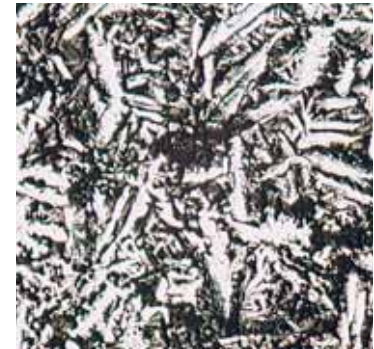
Abb. 8.6 DS-Aufnahme feinkörnige Schlacke (L 0,7 mm)
